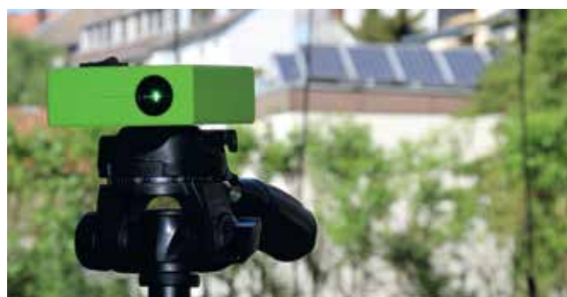
Παρακολούθηση και έλεγχος εργασιών ανύψωσης με χρήση διατάξεων τεχνολογίας laser
