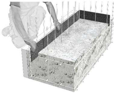
CEMflex in den Frischen Beton stecken (min 3cm)
