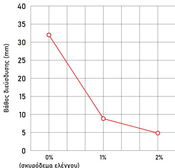
\*Βάθος διείσδυσης νερού ανάλογα με τη δοσολογία του Conplast Crystalline, βάσει ελέγχου σύμφωνα με το πρότυπο EN 12390-8, από το εργαστήριο δομικών υλικών του Τμήματος Πολιτικών Μηχανικών του ΑΠΘ.
