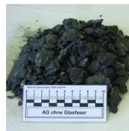
Ασφαλτικό κοκκώδες υλικός χωρίς ίνες υάλου (αριστερά) και με ίνες υάλου (δεξιά)
