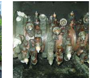
Τύμπανο της φρέζας μετά τη δοκιμή
