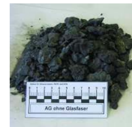
Ασφαλτικό κοκκώδες υλικό χωρίς ίνες υάλου (αριστερά) και με ίνες υάλου (δεξιά)
